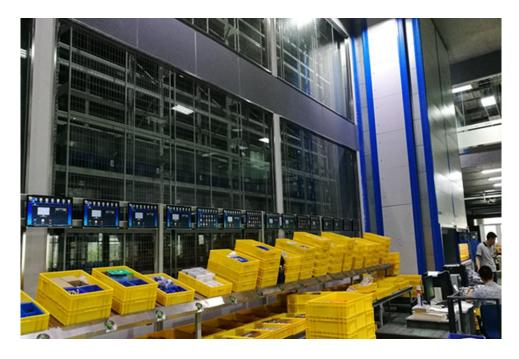
智能仓储管理系统以实用、便捷、经济的建设方式为原则,实现仓储管理各种自动化功能,完成:准确收货、在正确的地点存货、仓储存货管理、订单处理、分拣和配送控制及门店物流联动,帮助企业解决仓储管理方面的问题。能仓储有半自动与全自动。半自动多数是人□AGV□货架,仓库管理系统组成。而全自动智能仓储则主要由6系统组成,分别是:货架系统、堆垛机系统、托盘自动化系统、输送分拣系统、自动化控制系统、仓库管理信息化系统。在全自动智能仓储中\*\*的系统是自动化控制系统与仓库管理信息化系统。智能仓储整合是智能仓储的经济利益,通过这样的安装,整合仓库接收制定的货物,将其整合成为单一的装运,这样不只实现比较低的运输费,同时也减少货物运输的拥堵。此外,智能仓储可以进行内向转移和外向转移,从而整合成比较大的装运。自动仓库是指在不直接人工干预的情况下,能自动地存储和取出物料的系统。上海家装立体仓库
