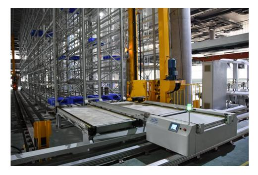
仓储有半自动与全自动。半自动多数是人[AGV]货架,仓库管理系统组成。而全自动智能仓储则主要由6系统组成,分别是:货架系统、堆垛机系统、托盘自动化系统、输送分拣系统、自动化控制系统、仓库管理信息化系统。智能仓储管理系统以实用、高效、便捷、经济的建设方式为原则,实现仓储管理各种自动化功能,完成;准确收货、在正确的地点存货、仓储存货管理、订单处理、分拣和配送控制及门店物流联动,帮助企业解决仓储管理方面的问题。智能仓储整合是智能仓储的经济利益,通过这样的安装,整合仓库接收制定的货物,将其整合成为单一的装运,这样不仅实现比较低的运输费,同时也减少货物运输的拥堵。此外,智能仓储可以进行内向转移和外向转移,从而整合成比较大的装运。
